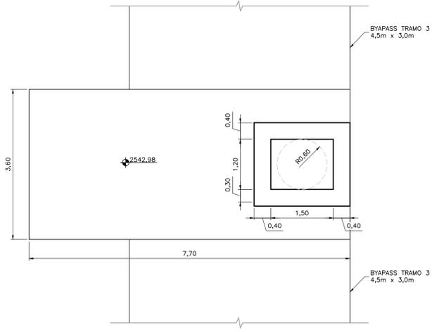
**MONTAJE MEDIDOR DE FLUJO PLANTA SUPERIOR**
