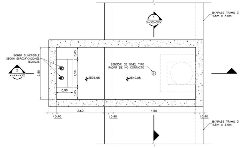
**MONTAJE MEDIDOR DE FLUJO PLANTA INFERIOR**
