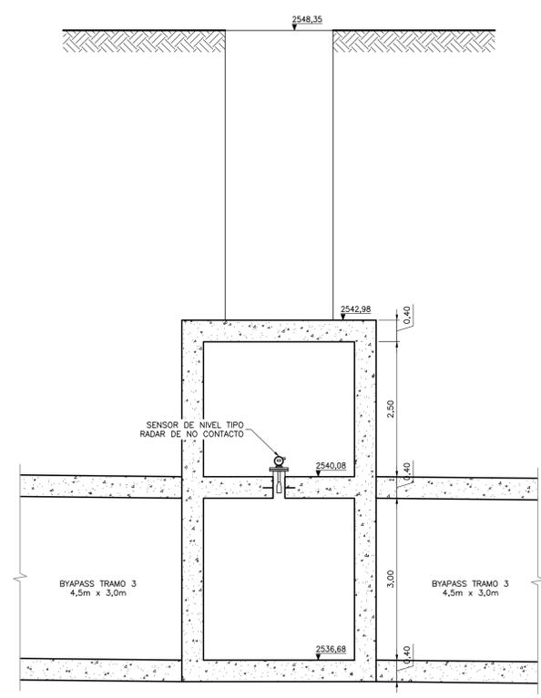
**MONTAJE MEDIDOR DE FLUJO SECCIÓN 1**
