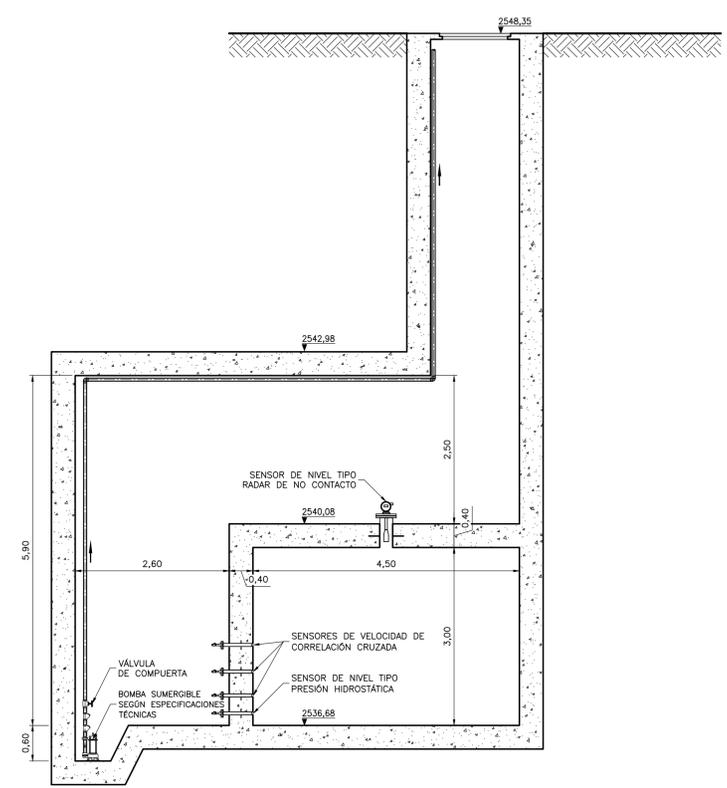
**MONTAJE MEDIDOR DE FLUJO SECCIÓN 2**
