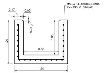
**DETALLE CÁRCAMO PREFABRICADO**
