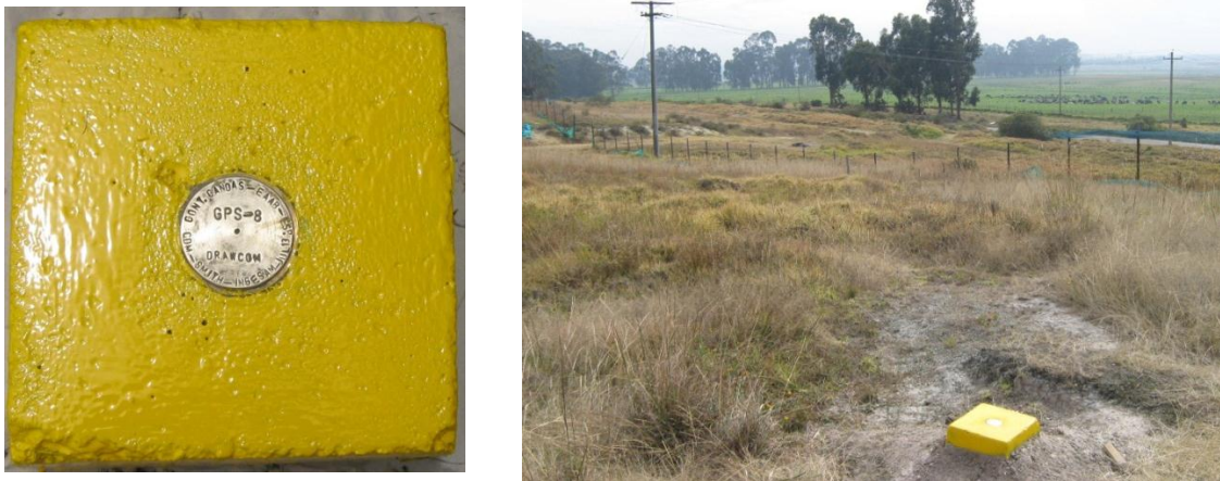
Figura 3-2 Vista de la monumentación de puntos GPS en el sitio del levantamiento
