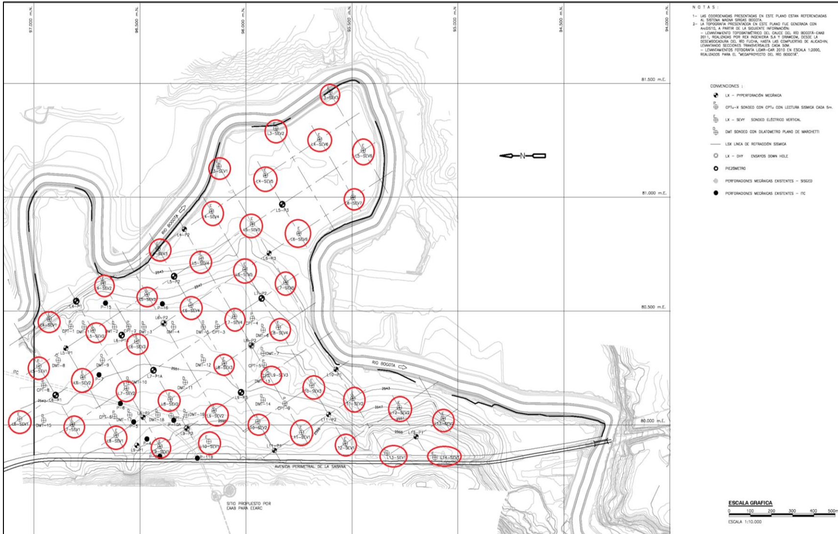
Figura 2-3 Localización de puntos de medición de resistividad eléctrica en el sitio de la PTAR Canoas
