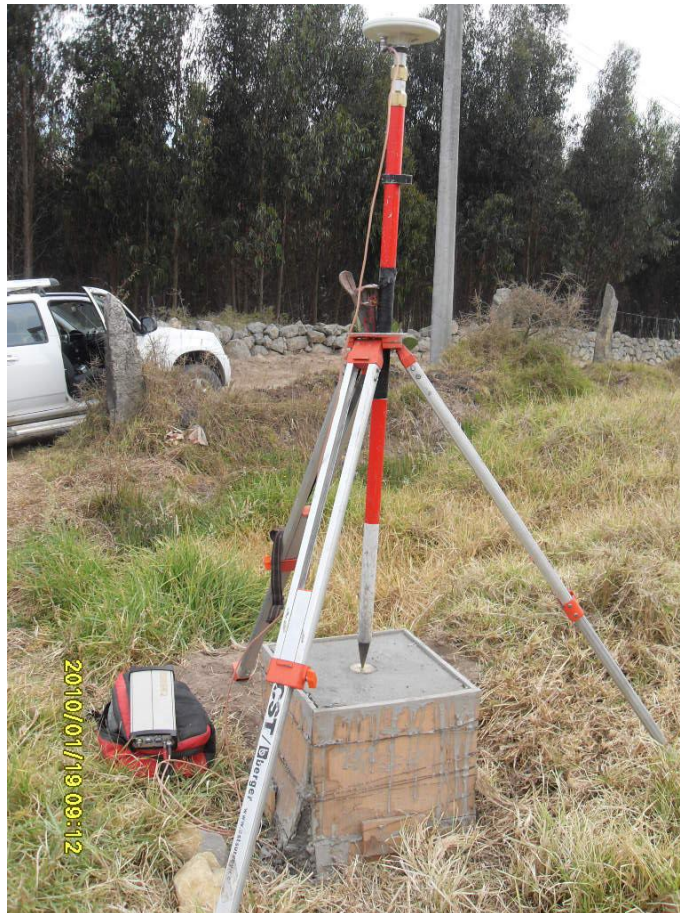
Fotografía 1 - Equipo base antena Trimble 4000ST L1/L2 Geodetic
