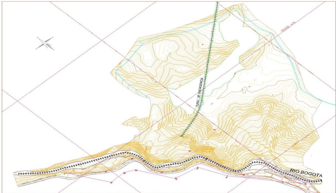
Figura 9. Levantamiento Topográfico de la plataforma y túnel de emergencia
