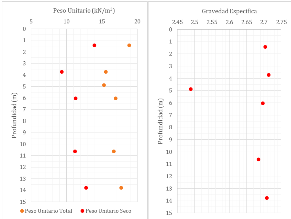
Figura 4-3 Peso unitario y la gravedad específica en profundidad.
