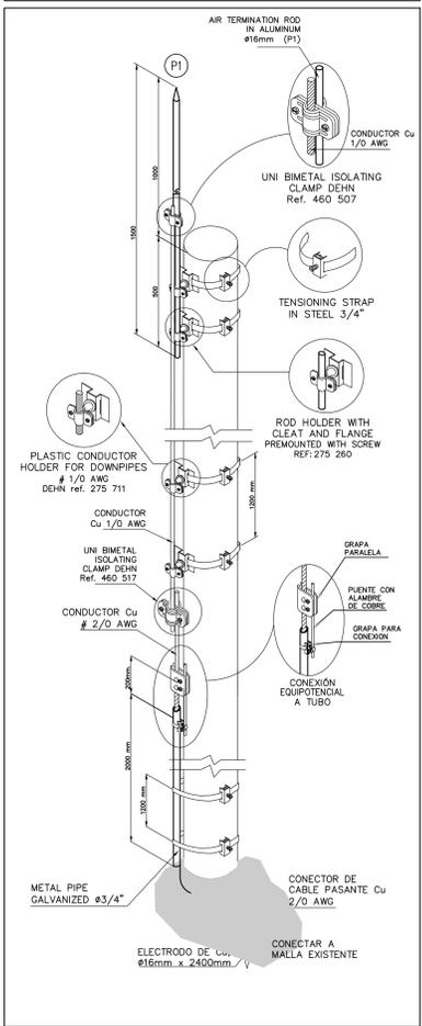
**FIJACIÓN PUNTA CAPTADORA SEDIMENTADORES**
