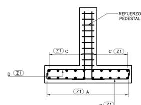
**SECCION TIPICA DE ZAPATA**
