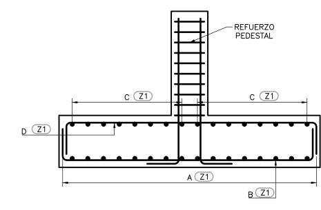
SECCION TIPICA DE ZAPATA
