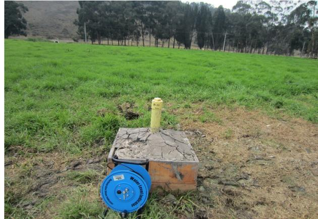
**REGISTRO DE TOMA DE MEDICIONES DE NIVEL DE AGUA DE LOS PIEZÓMETROS - PTAR CANOAS**
