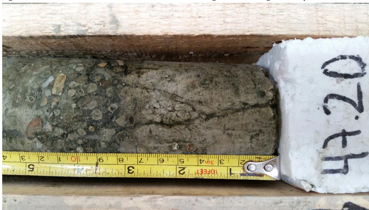
Figura 4-2 Perforación PF-14. Detalles de núcleos de roca biogénicas como algas fósiles y rodolitos.
