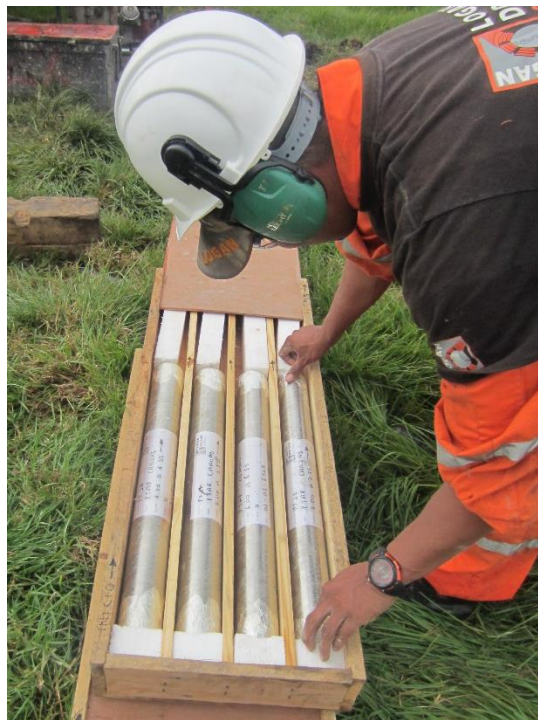
Figura 3-5 Almacenamiento de muestras inalteradas y alteradas en cajas de madera
