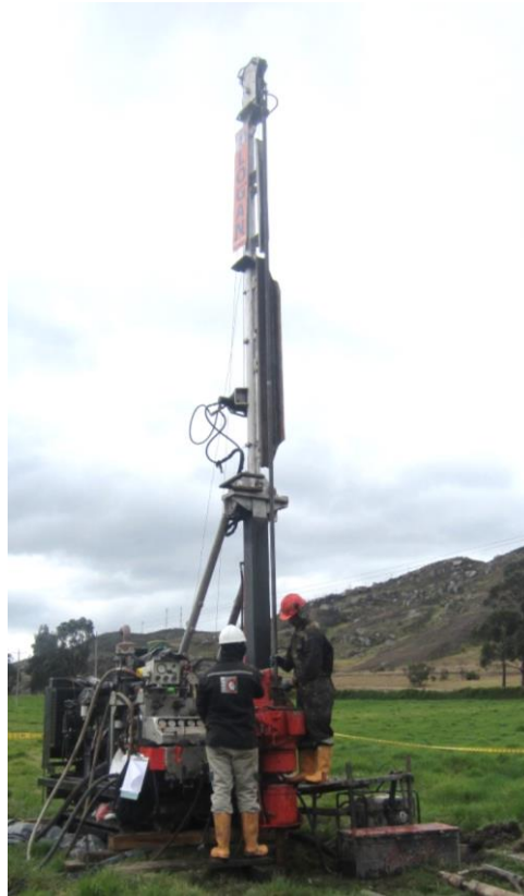
Figura 3-2 Equipos de perforación empleado DL800.
