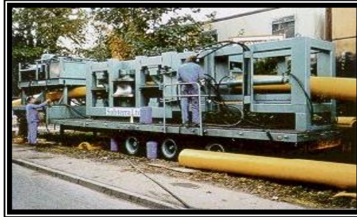
Figura No. 2.5.2. Rolldown – Equipo reducción del diámetro por rodillos. 9
