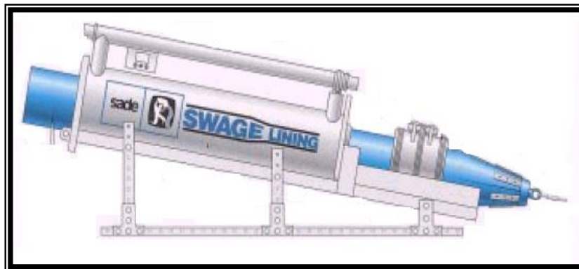
Figura No. 2.5.1. Swagelining – Esquema reducción del diámetro por temperatura. 8
