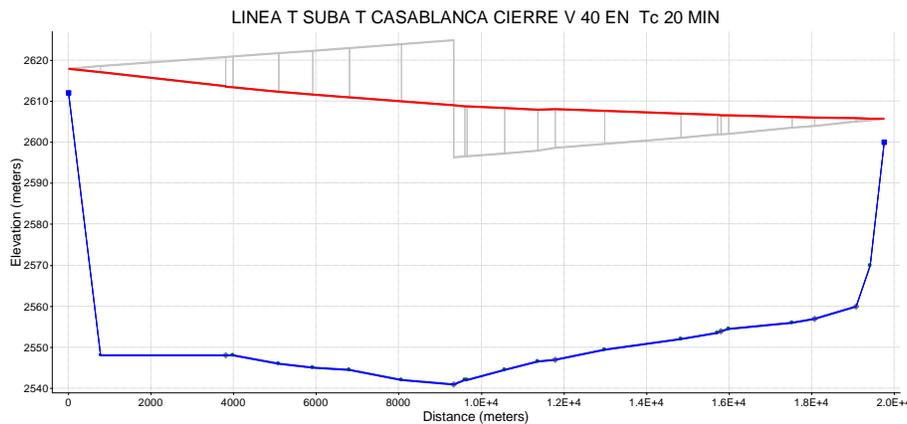
**Gráfica 5 – Perfil de la Conducción Tanque Suba Tanque Casablanca y Líneas de Máxima y de Mínima Presiones Producidas por Cierre de la Válvula V 40 en 20 Minutos.**
