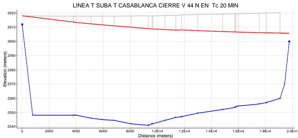
**Gráfica 4 – Perfil de la Conducción Tanque Suba Tanque Casablanca y Líneas de Máxima y de Mínima Presiones Producidas por Cierre de la Válvula V 44 en 20 Minutos.**
