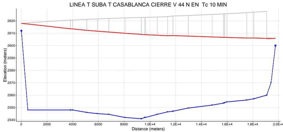
**Gráfica 3 – Perfil de la Conducción Tanque Suba Tanque Casablanca y Líneas de Máxima y de Mínima Presiones Producidas por Cierre de la Válvula V 44 en 10 Minutos.**
