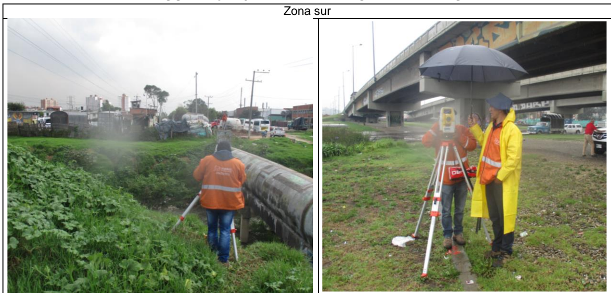
FIGURA No. 10 LEVANTAMIENTO DE DETALLES
