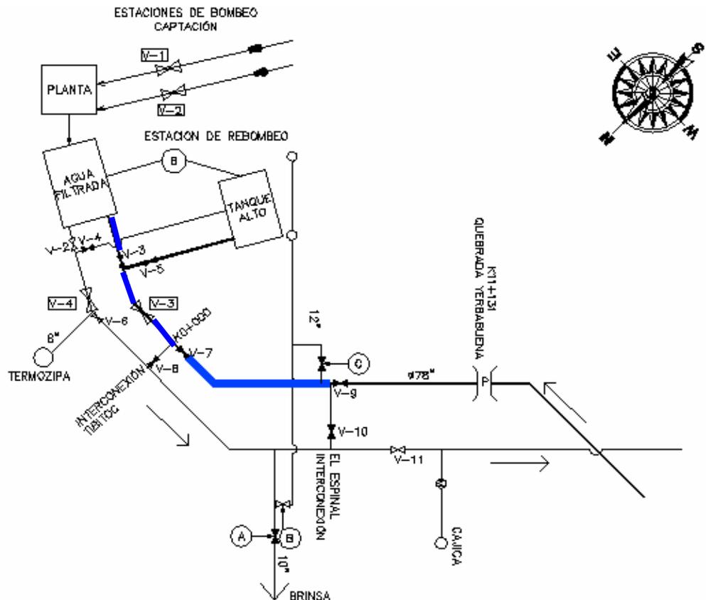
La operación consistiría en cerrar las interconexiones de Tibitoc y el Espinal, cerrar la válvula V-3 y V-9 y abrir la válvula V-4 y operar las derivaciones de la tubería de 78" a través de la de 60". Aguas abajo la Interconexión de La Caro entregaría el agua de la tubería de 60" a la tubería de 78".
