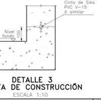
DETALLE 3 JUNTA DE CONSTRUCCIÓN
