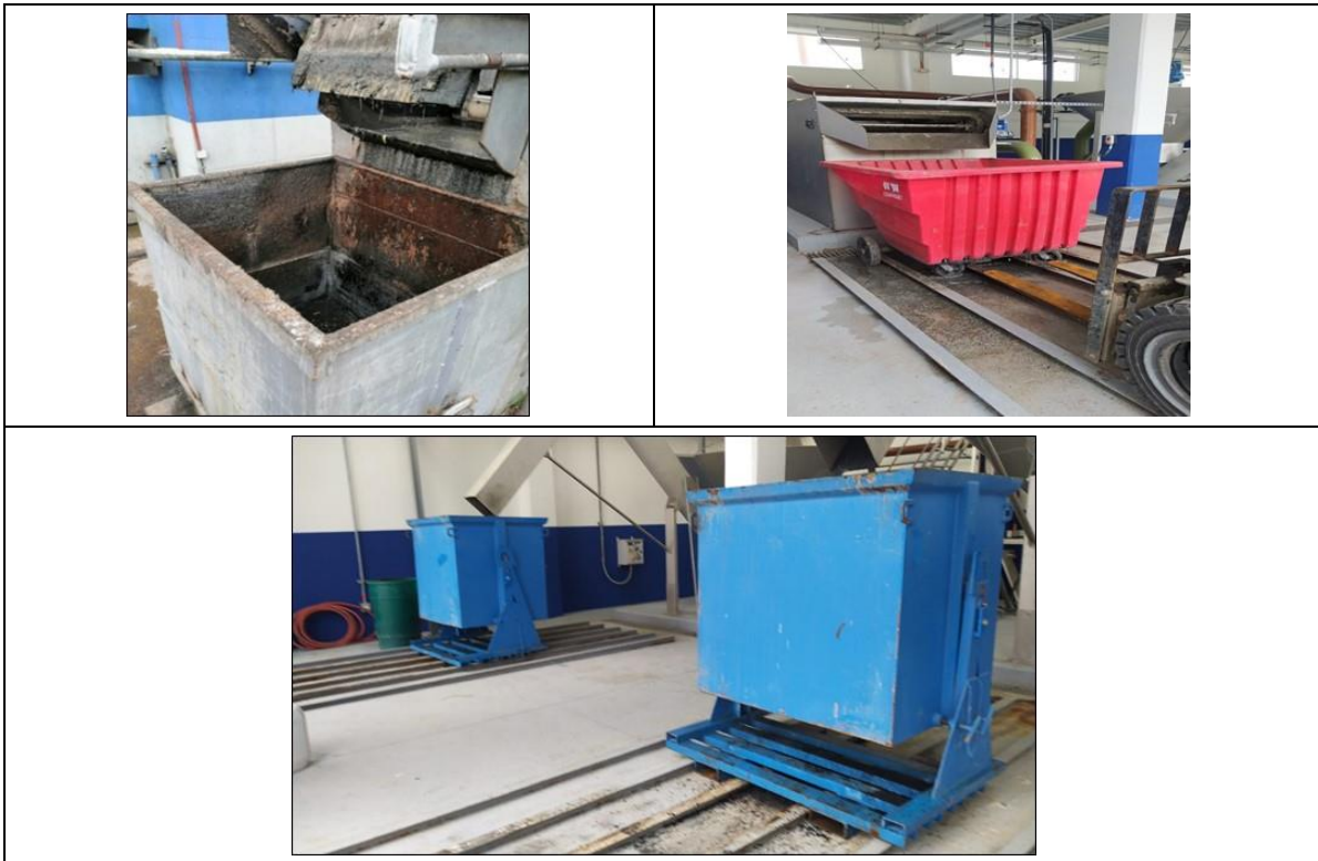
Fotografía 7. Residuos de pretratamiento provenientes del descargue de contenedores del material cribado resultante de Gruesos y Finos.
