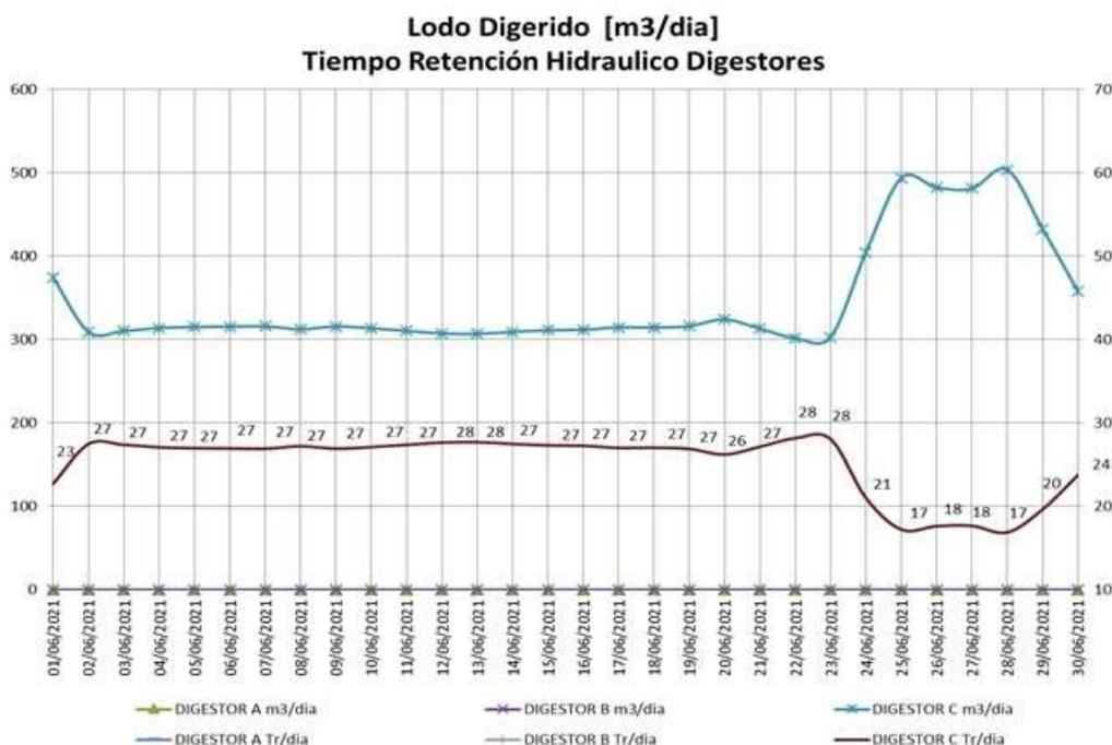
De la gráfica anterior se establece que el tiempo hidráulico se presentaron dificultades a lo largo del mes, en el manto de lodo de las estructuras del lodo almacenado, ocasionado por cargues de lodo primario por parte de fase II, al final del mes se aumentó el cargue, para evitar retorno de lodos a la línea de agua tratada. Como se observar hubo una disminución en los tiempos de retención y aumento de cargues en los digestor 9-3. Con el objetivo de generar dinamismo en la línea de lodo.
