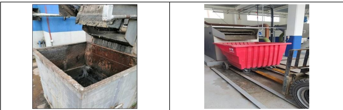
Fotografía 6. Contenedores del material cribado resultante de grasa galerías (sobrenadantes) y arenas
