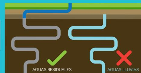
Conectar las tuberías de aguas lluvias y residuales a la red de alcantarillado que corresponda. Muchas personas cuando construyen sus casas, fábricas o comercios por desconocimiento conectan las aguas residuales en las redes de aguas lluvias o viceversa, lo cual conlleva a la contaminación de los ríos, canales y humedales en la ciudad.
