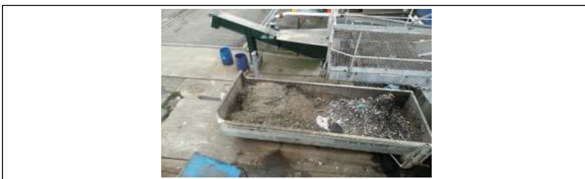
Fotografía 7. Contenedor ubicado sobre caída de banda proveniente del cribado fino.
