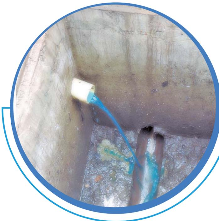
**3** En el pozo pluvial más cercano verifique la salida de agua con anilina.
