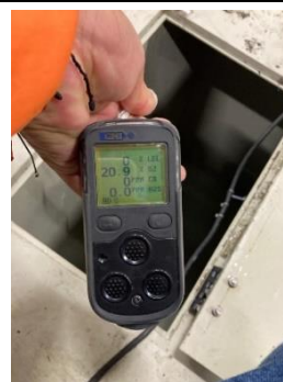
Toma de atmosferas en labores en espacios confinados.
